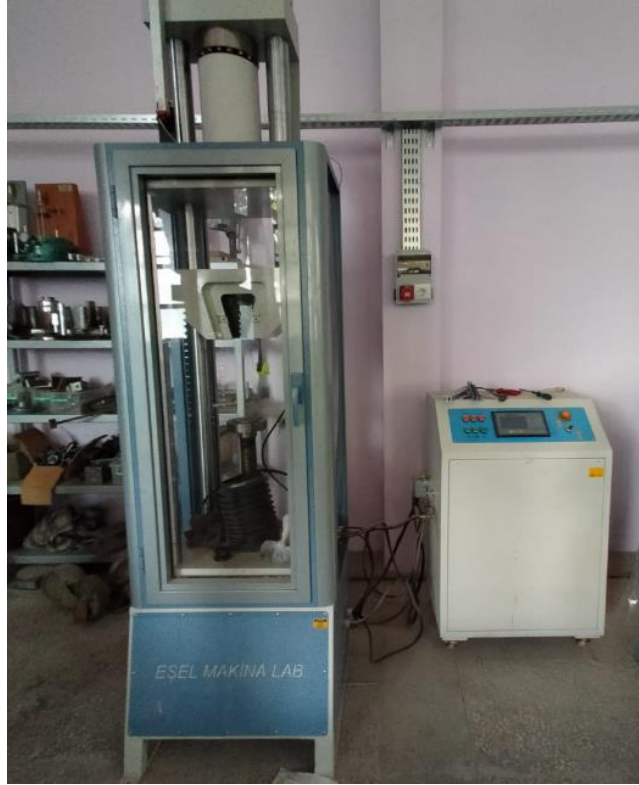
UTM (Universal Testing Machine) 600 kN donatı çekme deneyi aleti
